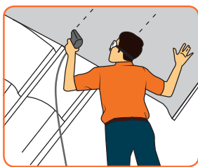
Тепло-, пароизоляция подкровельного пространства.
